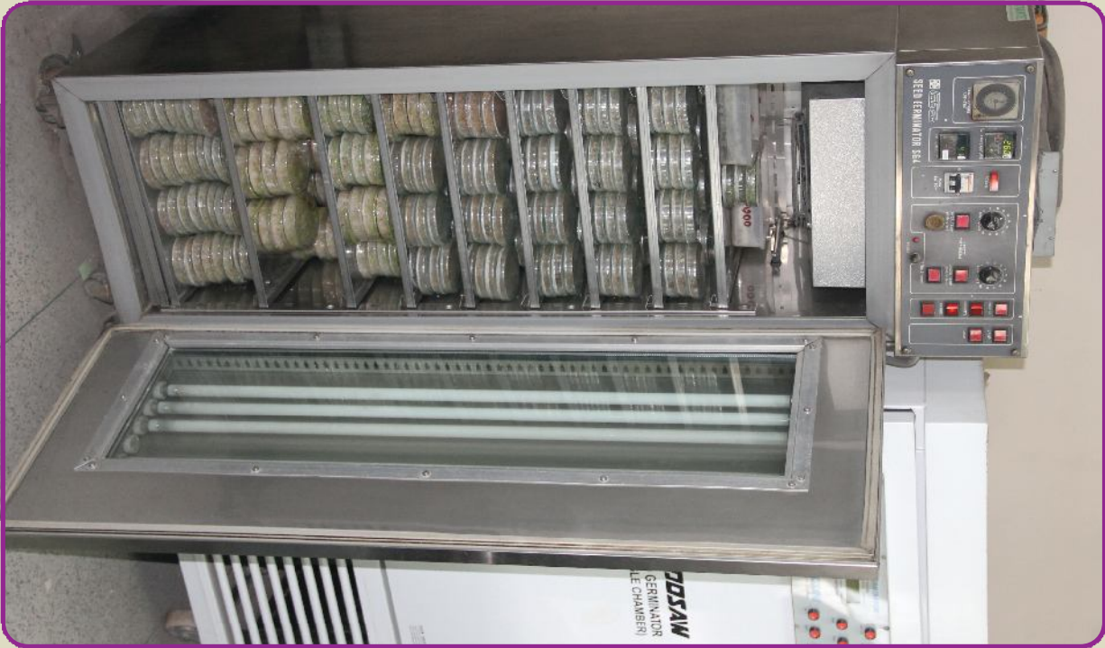
গাবতলীর বীজ ভবনে স্থাপিত বীজের অঙ্কুরোদগম ক্ষমতা পরীক্ষার যন্ত্র
